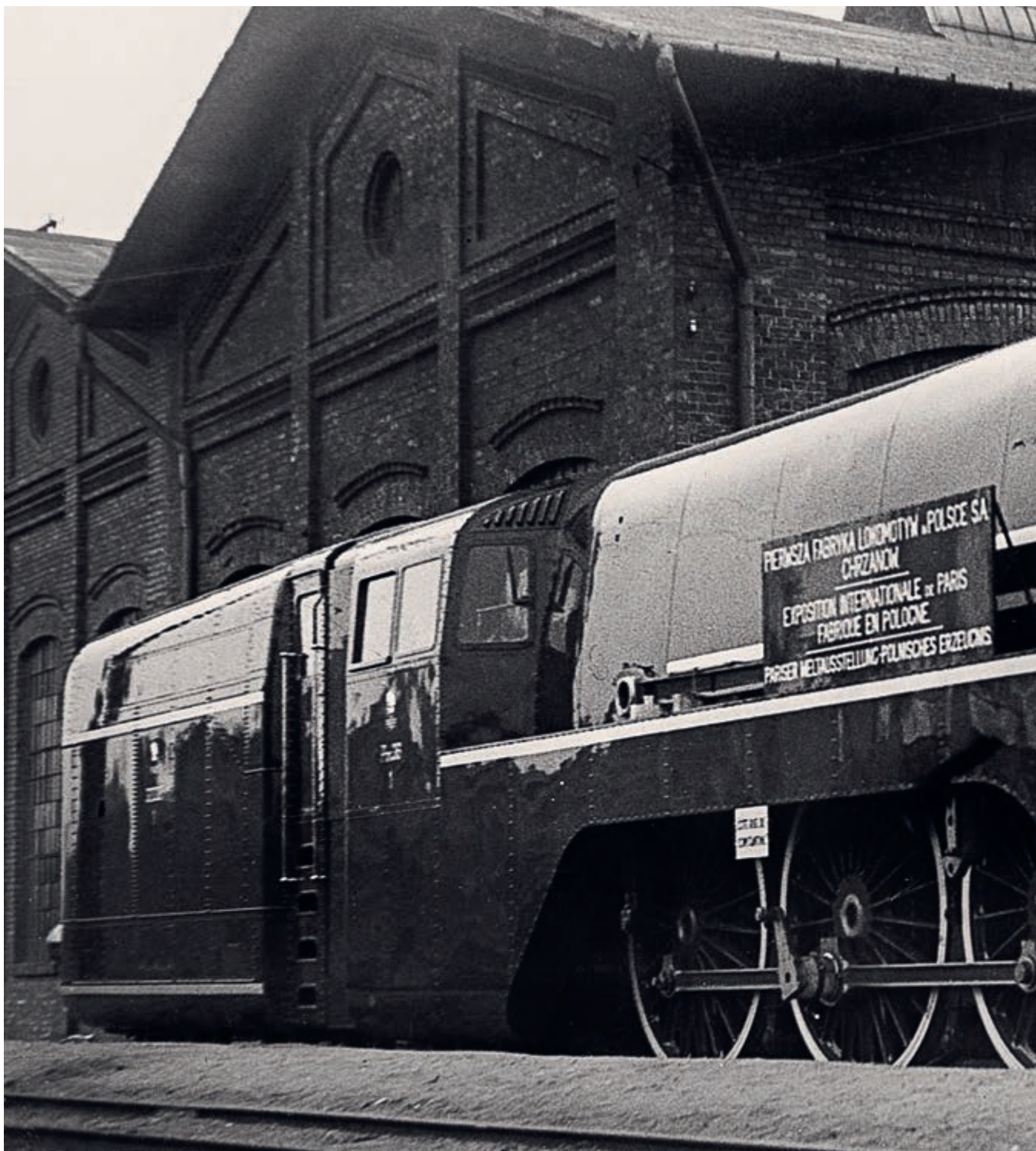
Parowóz serii Pm36 z otuliną aerodynamiczną konstrukcji Kazimierza Zembruskiego wyprodukowany w Fabryce Lokomotyw w Chrzanowie. Parowóz otrzymał złoty medal na wystawie światowej w Paryżu w 1937 roku
